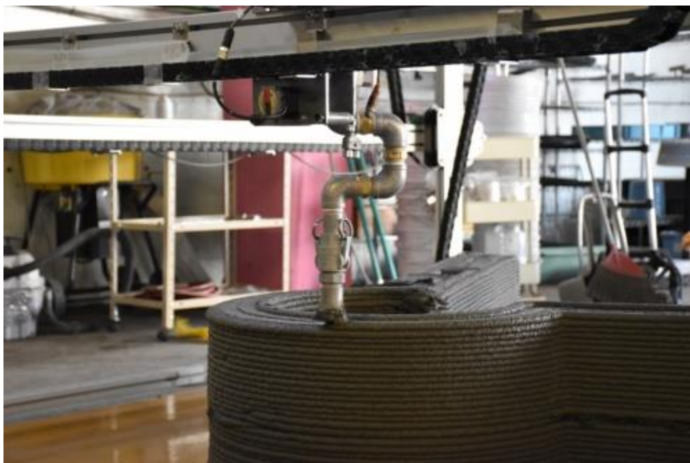
ポリウスの建設 3D プリンターで建物の部材を印刷する様子。
